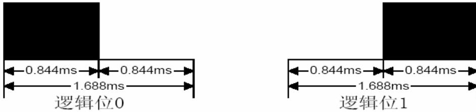
6122 的发射码采用 PPM (脉冲位置调制)，0 与 1 的波形说明如下图：
